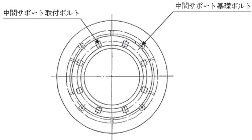
図 3-3 サポート部の応力計算モデル
