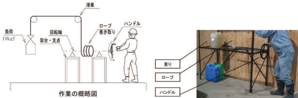
図4-2 試験概要図（3人で15回ずつ操作する）
