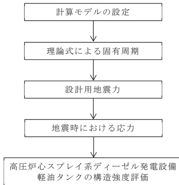
図 2-1 高圧炉心スプレイ系ディーゼル発電設備軽油タンクの耐震評価フロー
