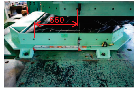
せん断変形後状況 (せん断 550mm)
