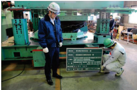
伸び+せん断変形後状況 (伸び 200mm, せん断 350mm)
