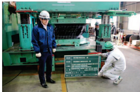
伸び+せん断変形後状況 (伸び 350mm, せん断 200mm)
