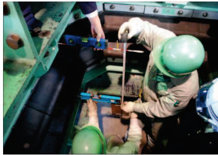
伸び変形量 (棒間距離) 計測状況 (計測値 570mm - 初期値 370 mm * = 伸び 200mm)
