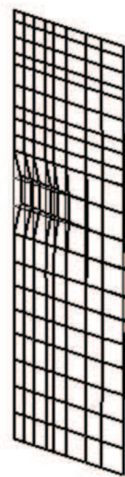
図 6.2-2(3) 変形図（地震時（地下トレンチ② 左側））
