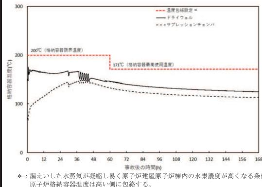
図 2.2.1-6 原子炉格納容器温度（有効性評価シナリオ条件（代替循環冷却系を使用できない場合（原子炉格納容器フィルタペント系を使用する場合）））
