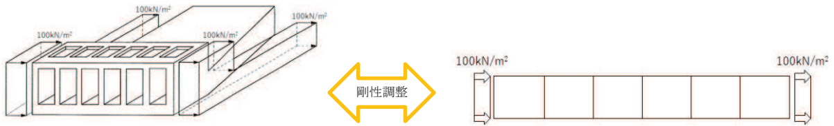
図 三次元モデルと等価剛性モデルの変位比較
