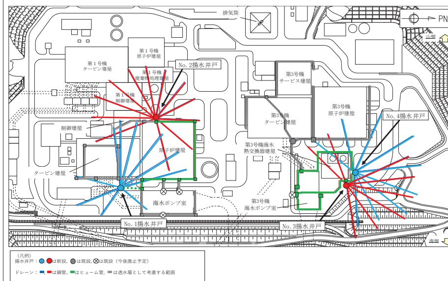
地下水位低下設備は、原子炉建屋・制御建屋エリア及び第3号機海水熱交換器建屋エリアにそれぞれ2基設置した揚水井戸に対し、揚水井戸ごとに必要な機能及び機器を「1系統」と位置付け、1系統で各エリア内の地下水位を一定の範囲に保持できる設計とする。
