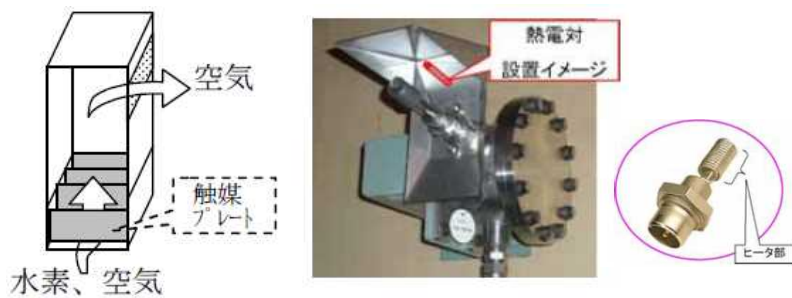
図1. 静的触媒式水素再結合装置（PAR）及びイグナイタの構造
