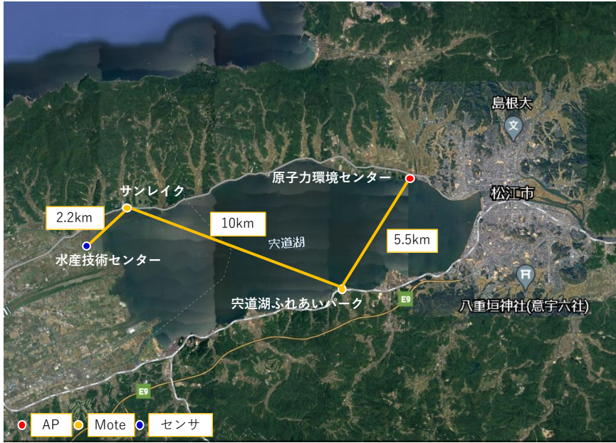
図 29 長期通信安定試験用に設置した通信経路。图中 AP は基地局、Mote は中継機、センサは端末となる。基地局から 2 段中継した後水産技術センターに設置された端末に接続する形である。
