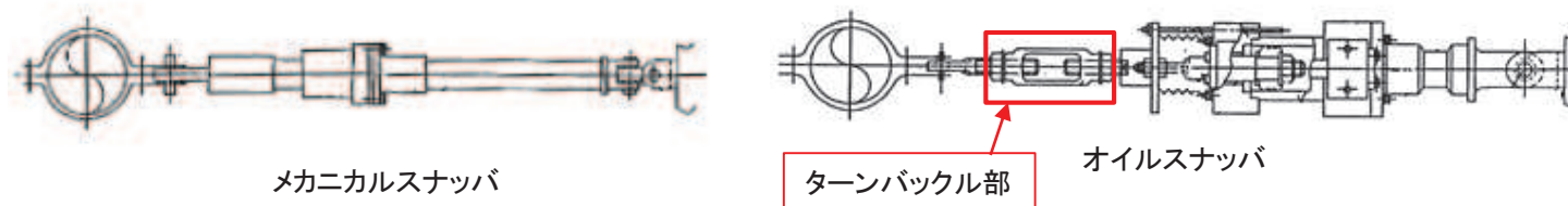
メカニカルスナツバとオイルスナツバの概略構造
