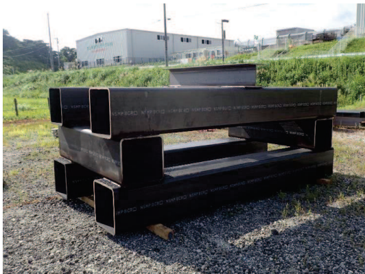
写真1 模擬がれき設置
