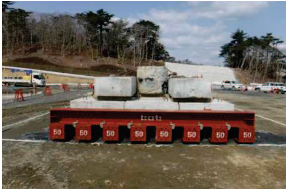
写真1 模擬がれき設置
