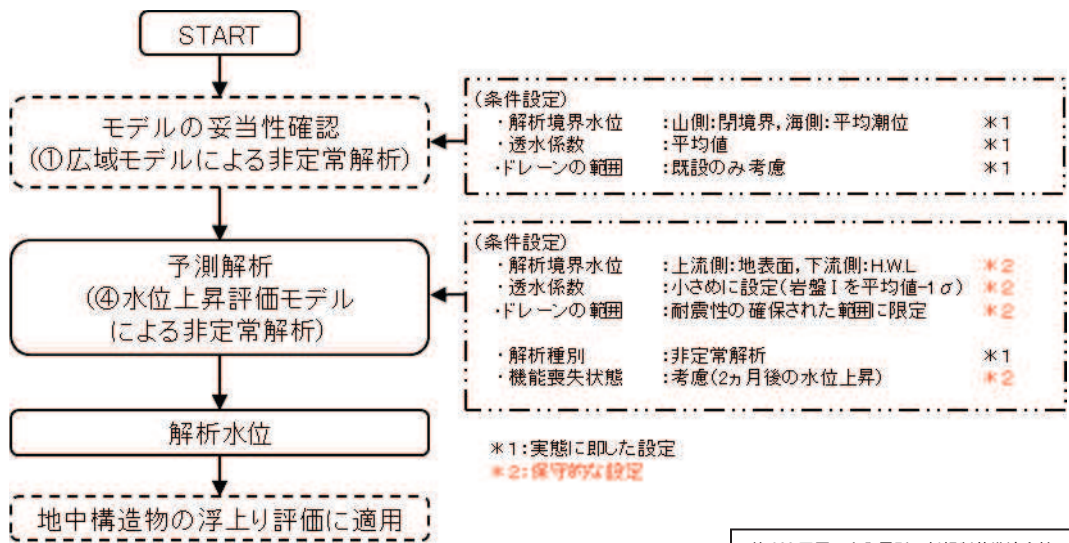
図9.1.2-3 屋外アクセスルート (O.P. 14.8m盤) の浮上り評価等に用いる浸透流解析フロー
