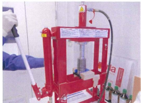
図 2-2-12 測定試料整形用のプレス機
