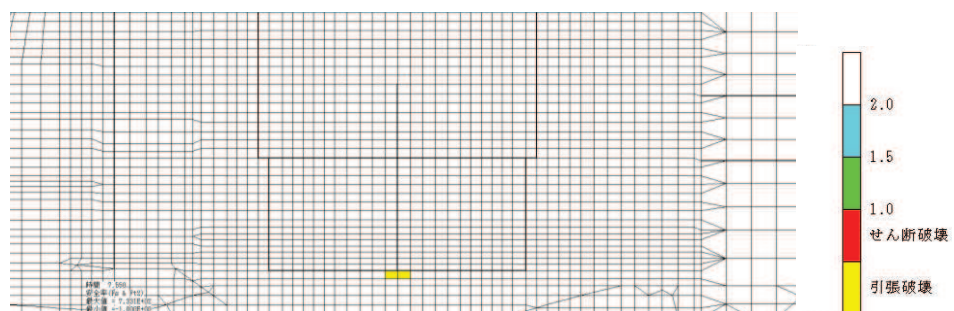
図 6-71 MMR (既設) の引張応力最大時刻の局所安全係数 (ケース③, 地震動 S_s - N1 (++) , 循環水ポンプエリア, t = 7.55s )
