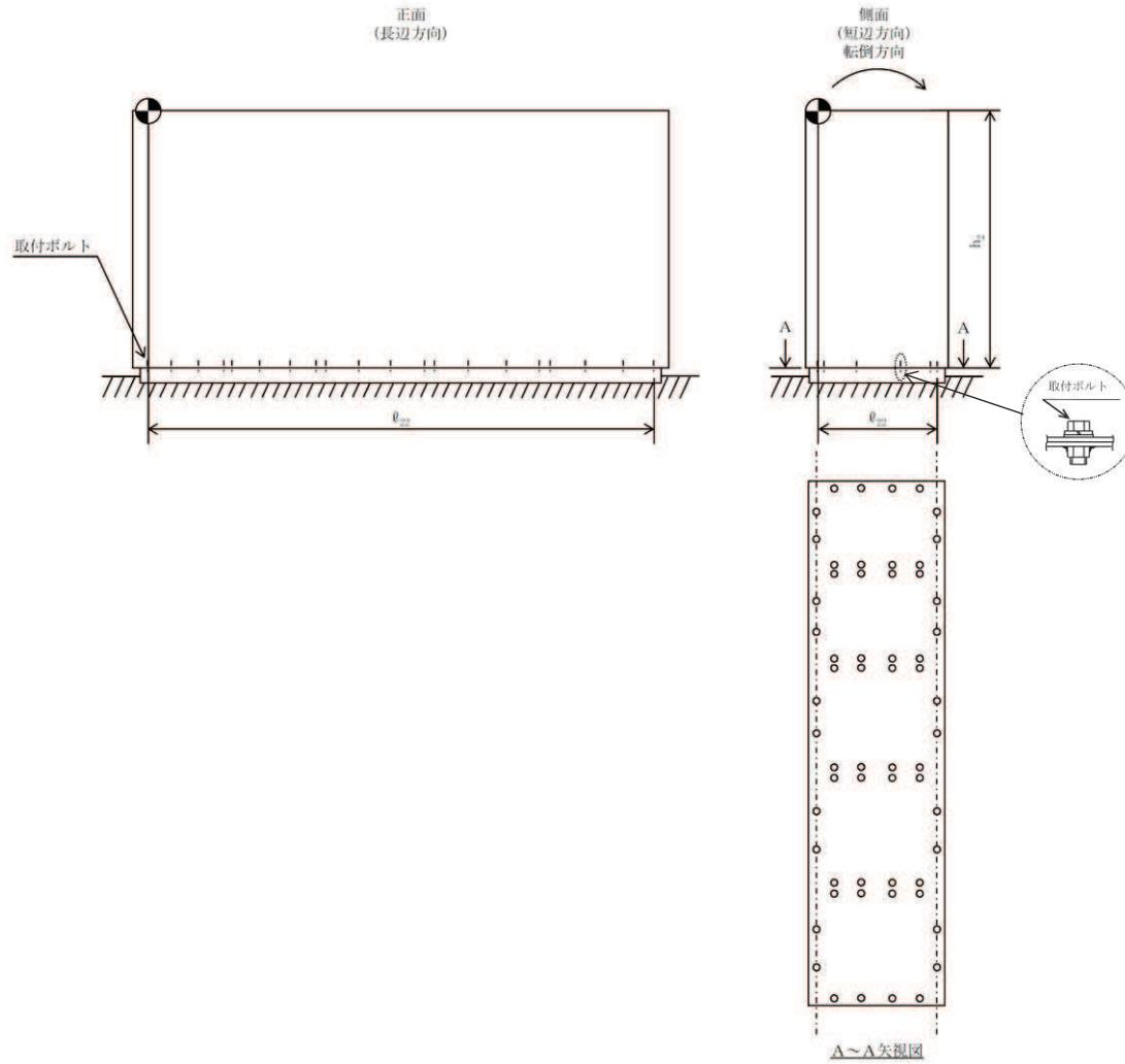
【非常用ディーゼル発電機 2B 制御盤の耐震性についての計算結果】
