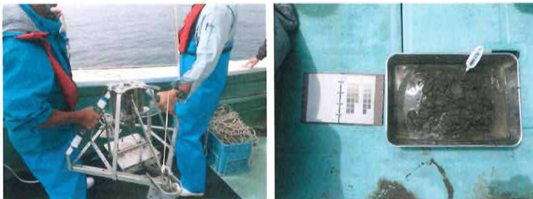
図 2-4 海底土試料の採泥状況
