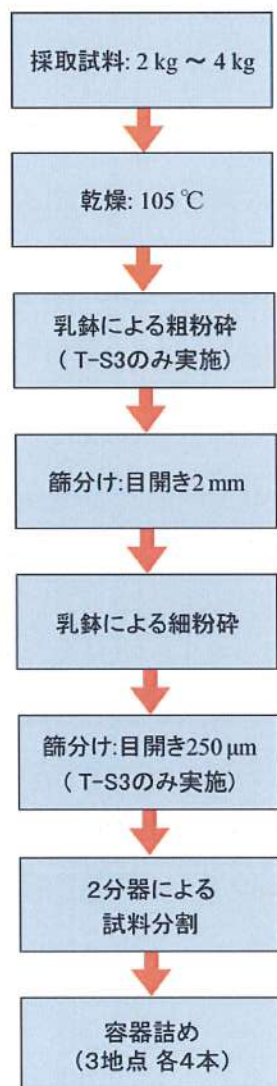
図 2-4 海底土試料の調製フロー
