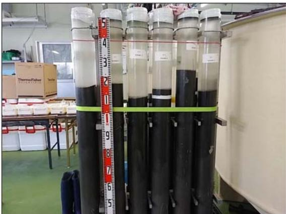
鉛直分布用柱状海底土試料の固定状況
