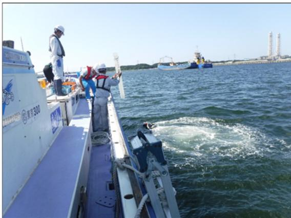
鉛直分布用柱状海底土試料の採取状況
