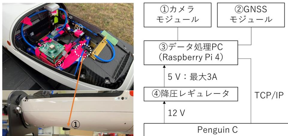
Fig. 5-18 通信テストに用いた D-P2 の概要
