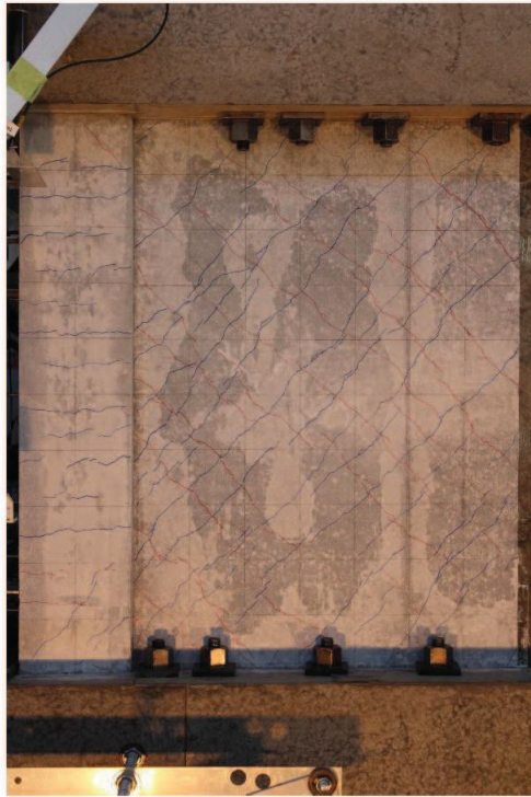
図 3-14 試験体 S-13-DII 事前加力終了時 (2/1000rad.) 写真
