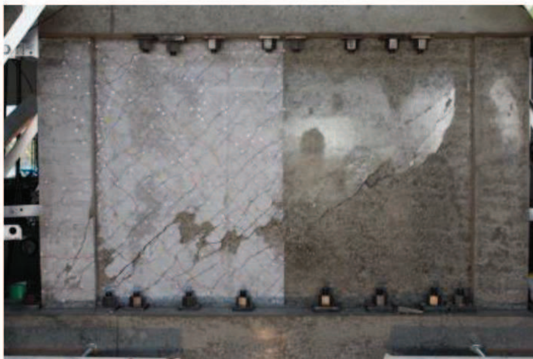
図 3-2 試験体 S-13-D0 最終破壊時写真
