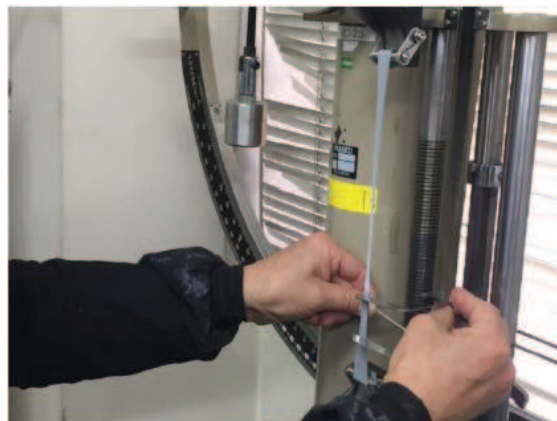
図 6.1.5-35(4) シリコーン材の耐候性試験 (引張試験)
