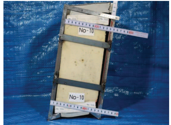
図 6.1.5-24(4) ウレタンシリコーン目地変形試験状況
