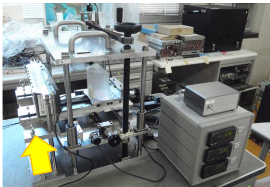
図 4. 1. 2 線源位置決め治具に JAEA 開発の検出器を取り付けた様子 JAEA 検出器を矢印で示している
