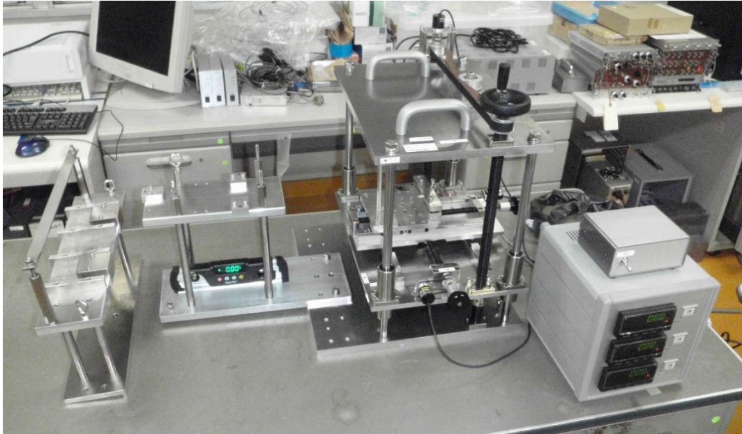
図 4. 1. 1 線源位置決め治具一式外形図
