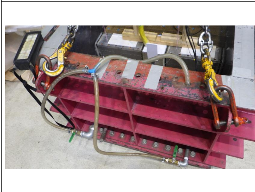
14. 粘性流体注水の剛土槽配管
