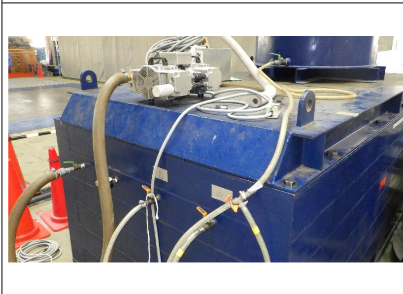
15. 脱気、注水の真空土槽
