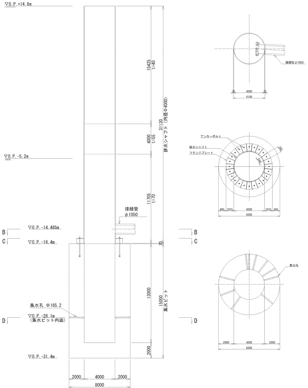
図 2-3(1) No.1 揚水井戸 構造図 (単位: mm)
