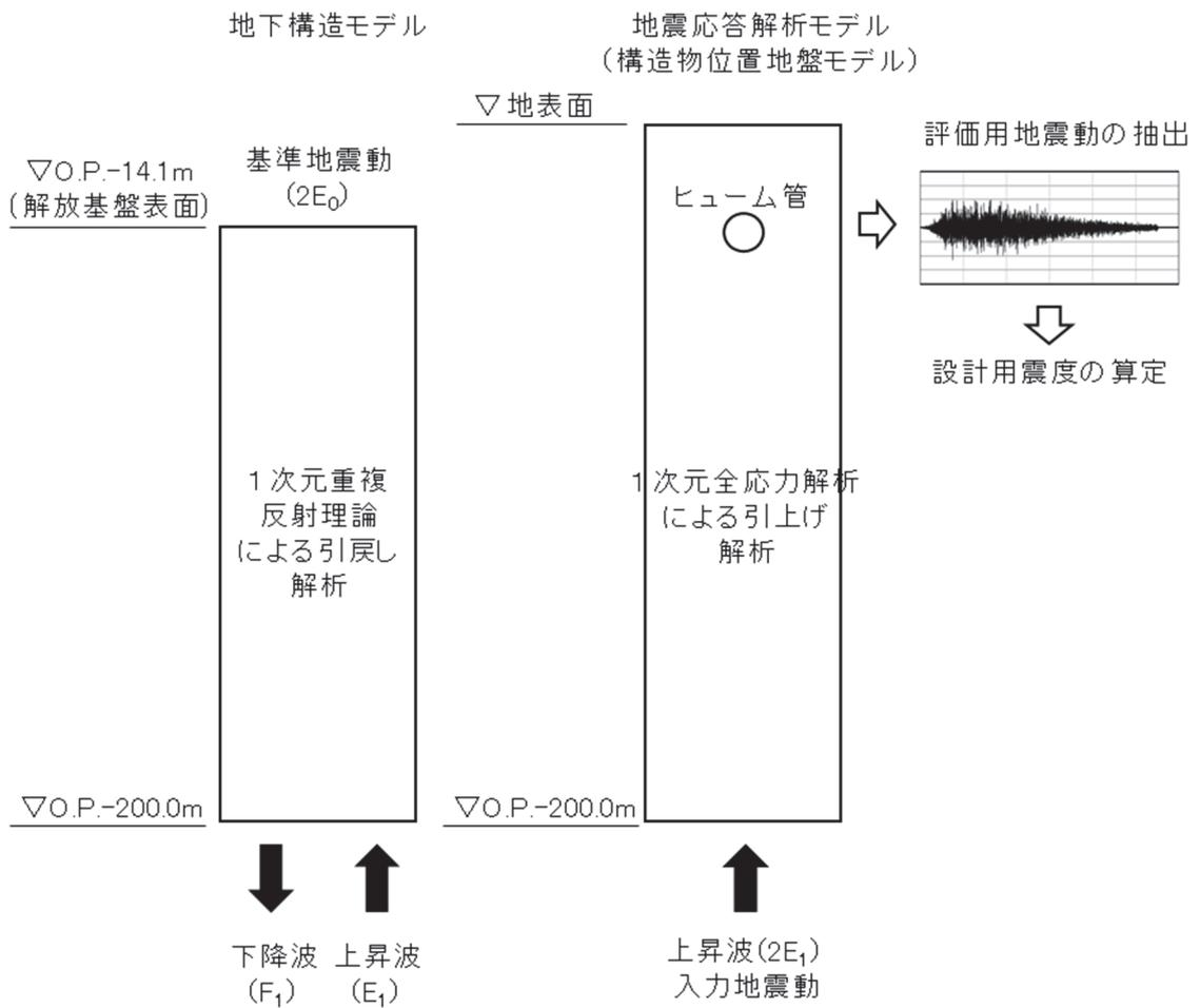
図 3-7 地震応答解析の概念
