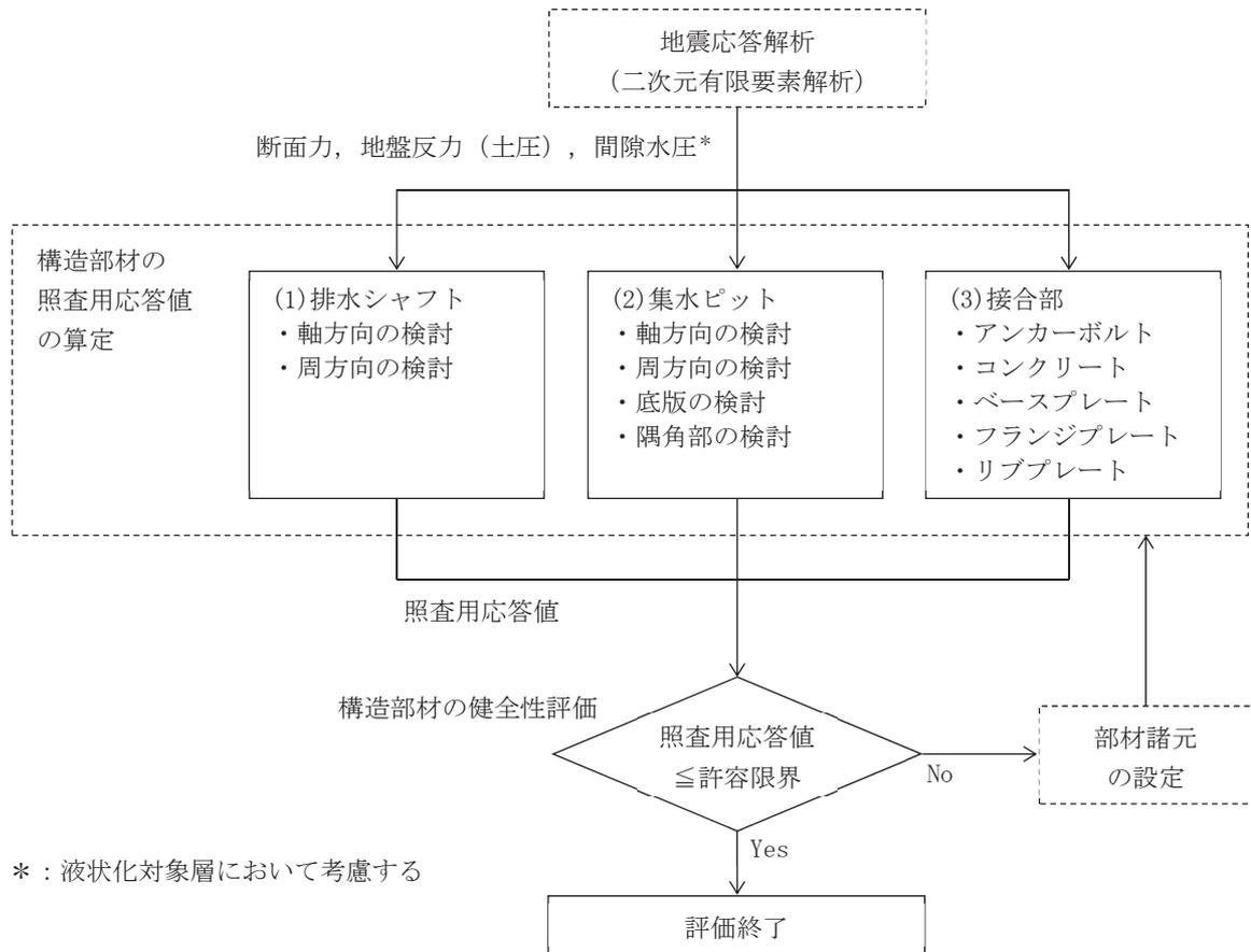
図 2-7 揚水井戸の詳細耐震評価フロー
