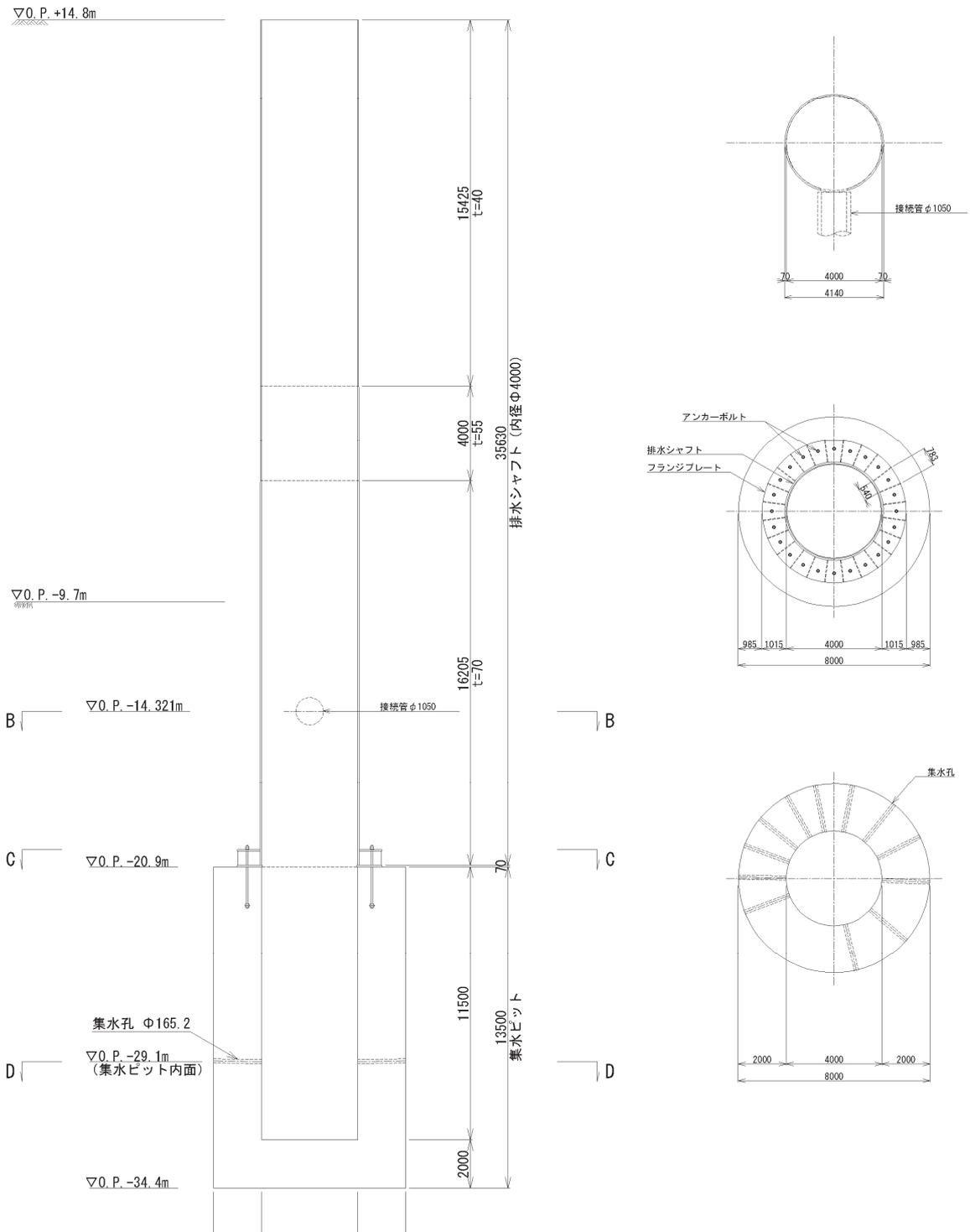
図 2-3(2) No.2 揚水井戸 構造図 (単位: mm)
