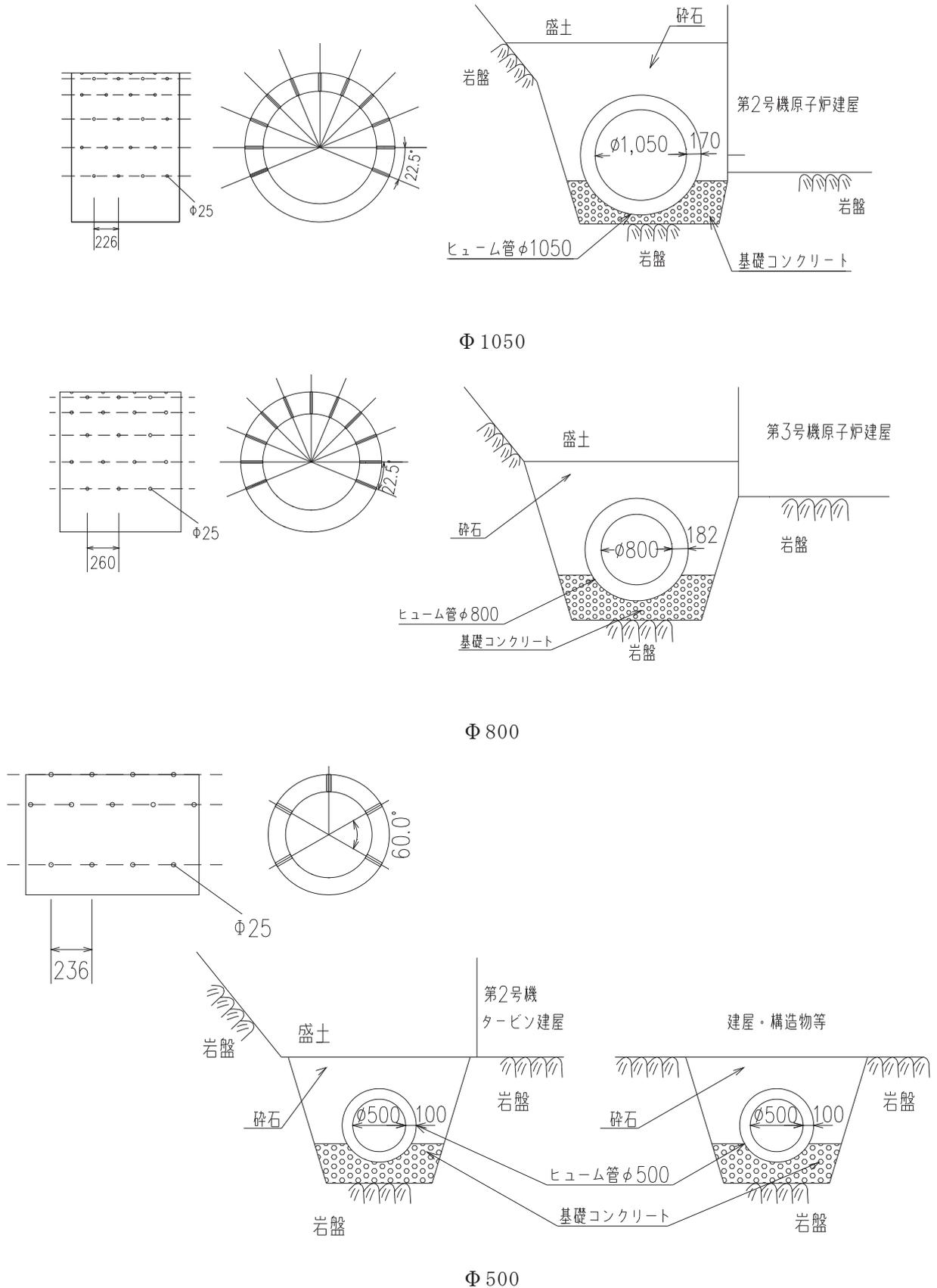
図 2-3 ヒューム管の構造概要 (単位: mm)
