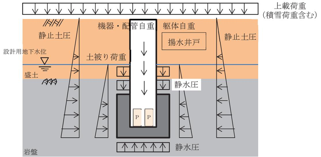
図 3-9 揚水井戸の荷重概要図
