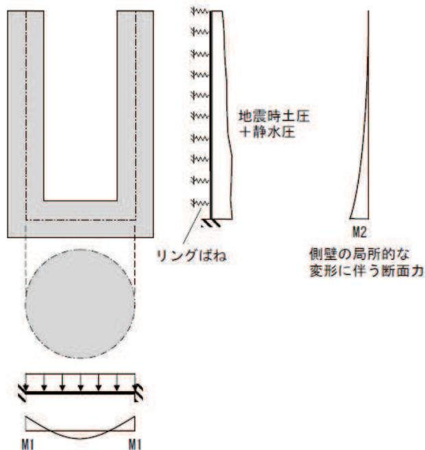
図 3-24 隅角部の評価の概念図
