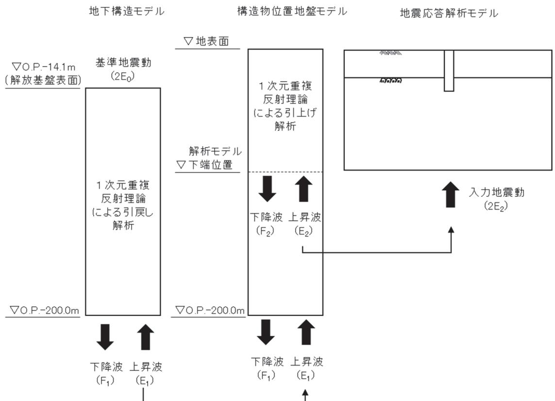
図3-10 入力地震動算定の概念図
