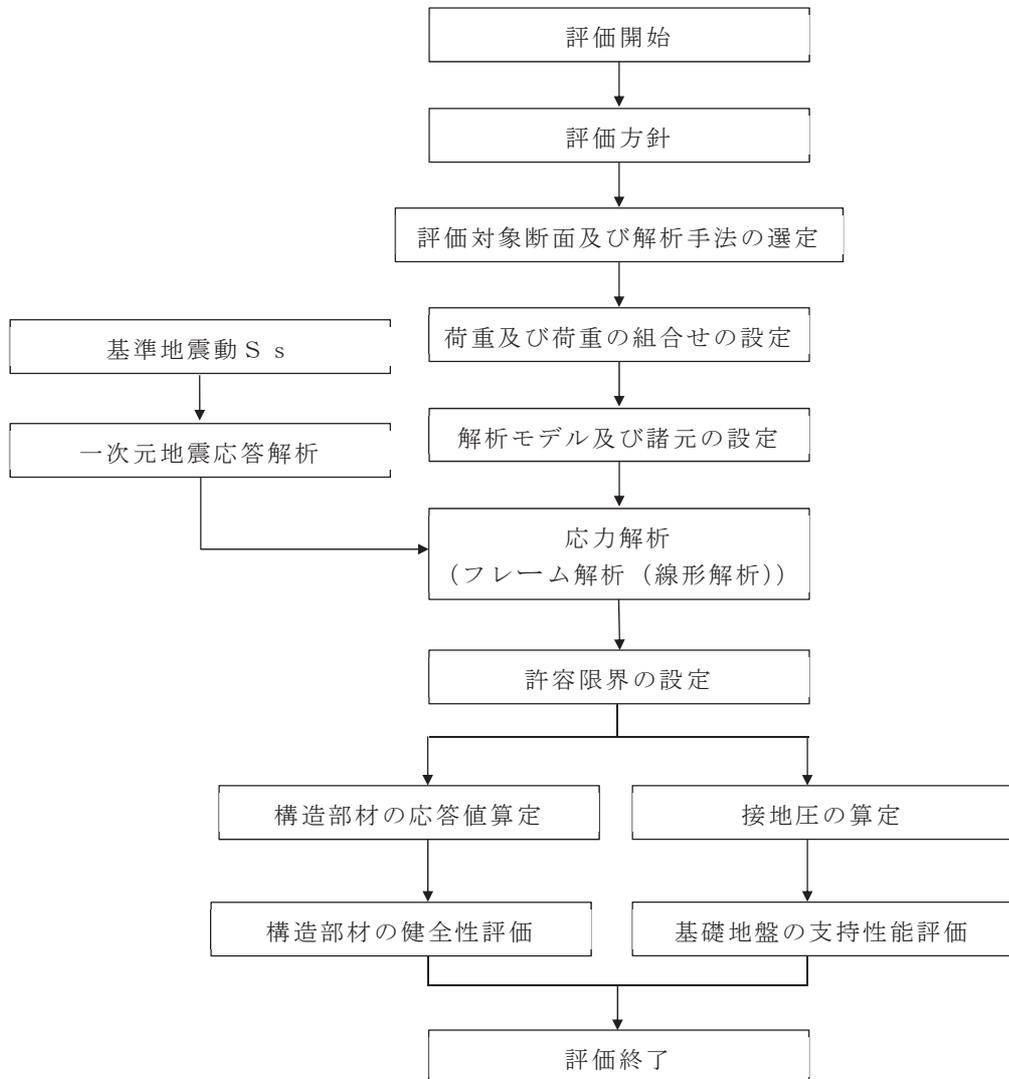
図 2-5 ヒューム管の耐震評価フロー
