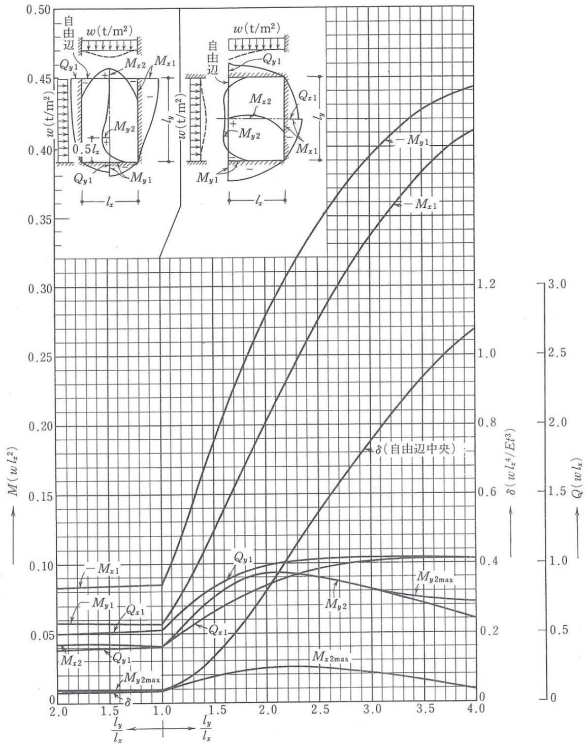
図3-10(2) 等分布荷重時3辺固定1辺自由スラブの応力図と自由辺中央のたわみ  $\delta$  ( $\nu=0$ )
