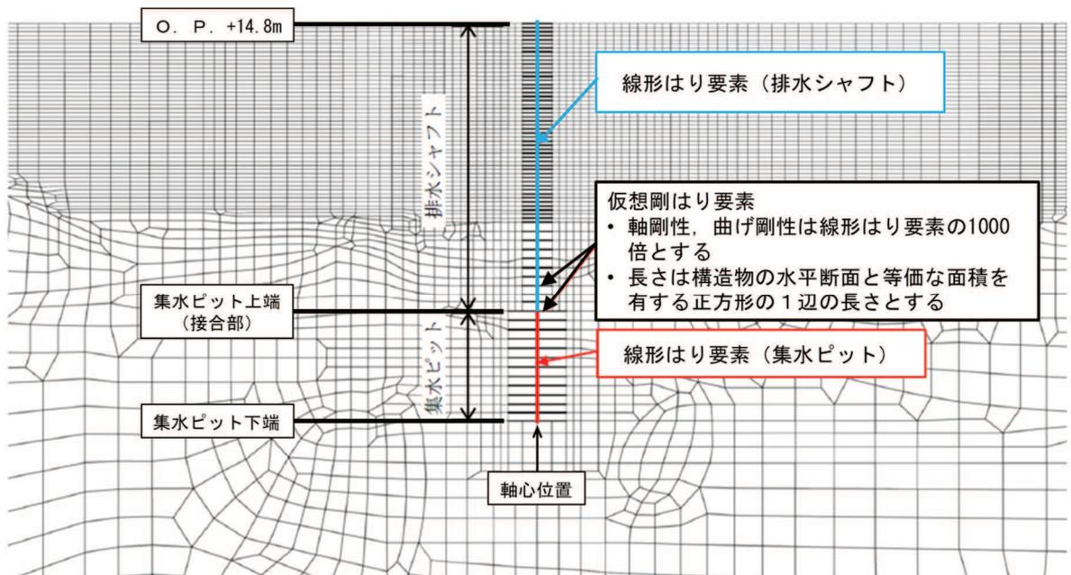
図 3-16 構造物の解析モデル
