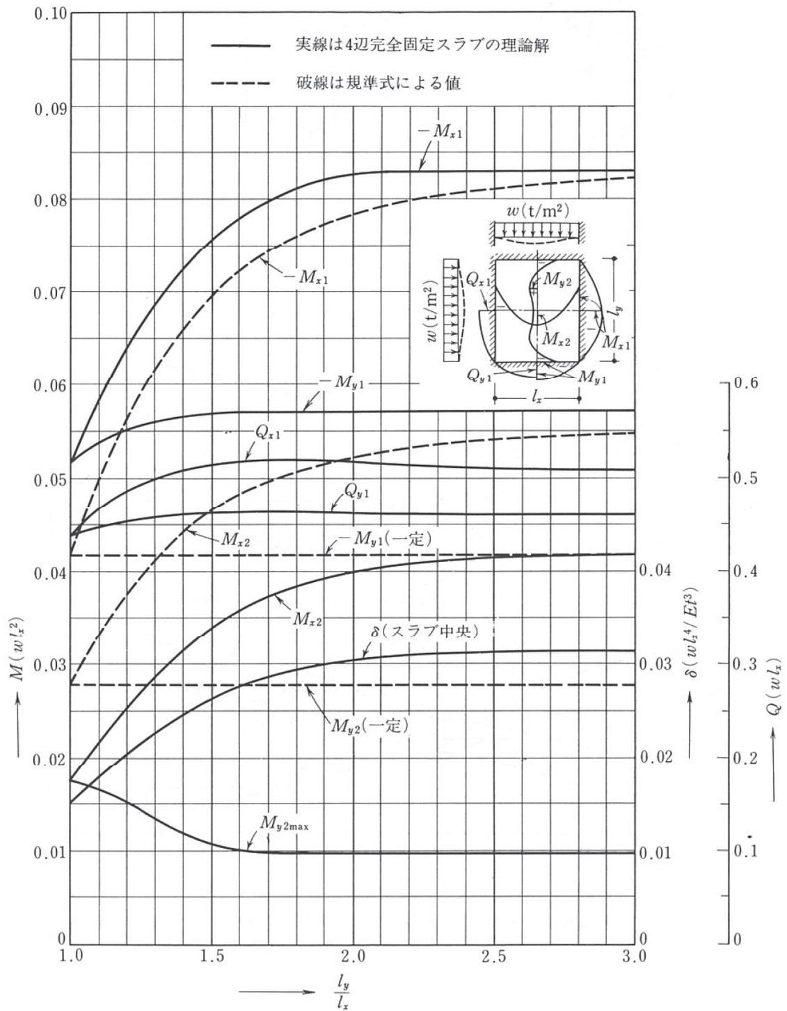
図 3-10(1) 等分布荷重時 4 辺固定スラブの応力図と中央点のたわみ  $\delta$  ( $\nu = 0$ )
