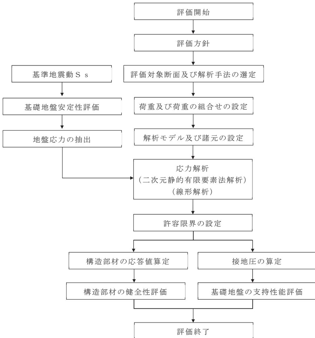
図 2-6 鋼管の耐震評価フロー
