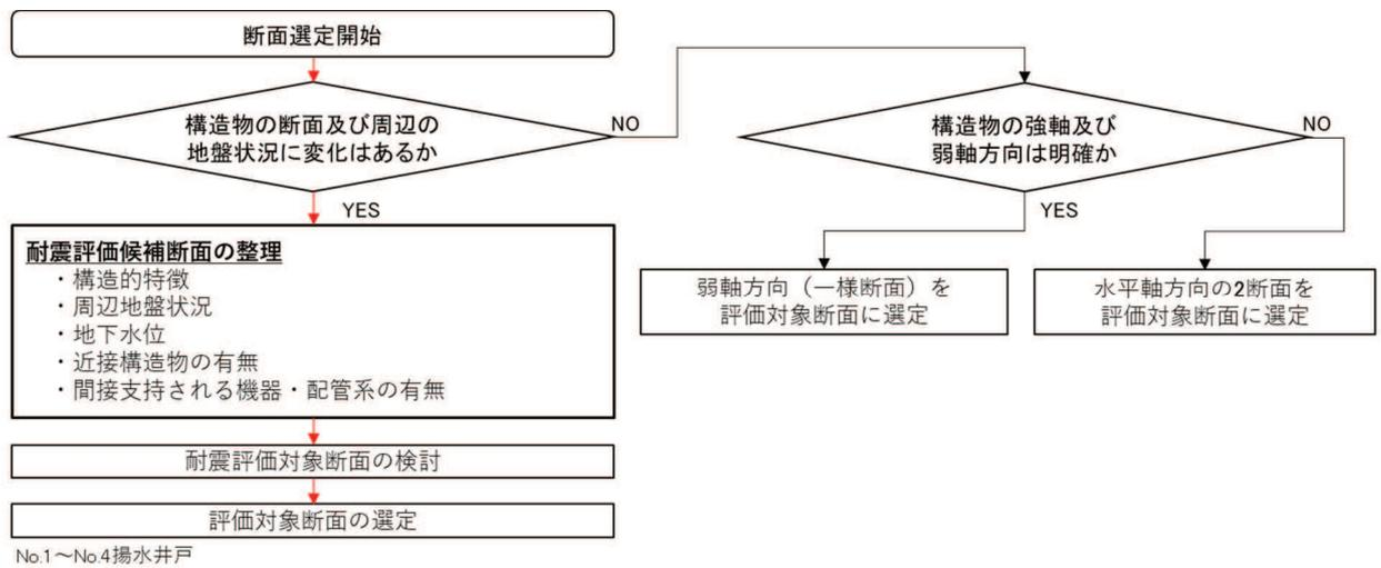
図 3-1 耐震評価の断面選定フロー
