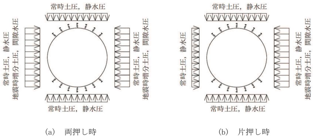
図3-20 二次元静的フレイム解析モデルの概念図（排水シャフト）
