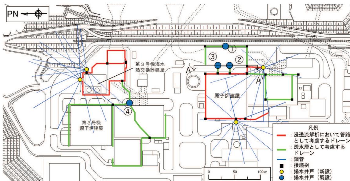
図 1 地下水低下設備配置概要
