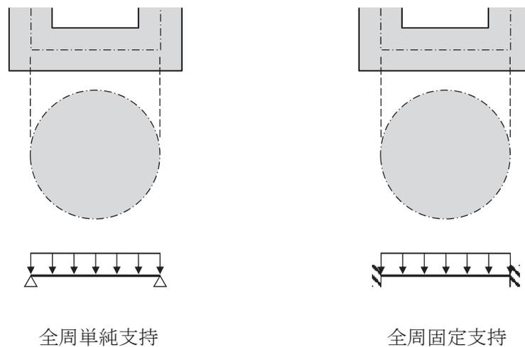
図 3-23 底版の検討モデル（円板）の概念図
