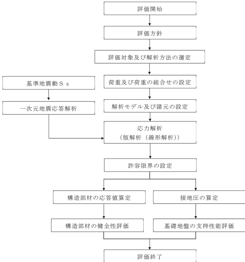
図 2-3 接続柵の評価フロー
