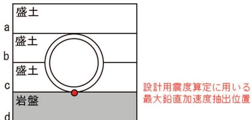
図 1 地震応答解析モデル図
