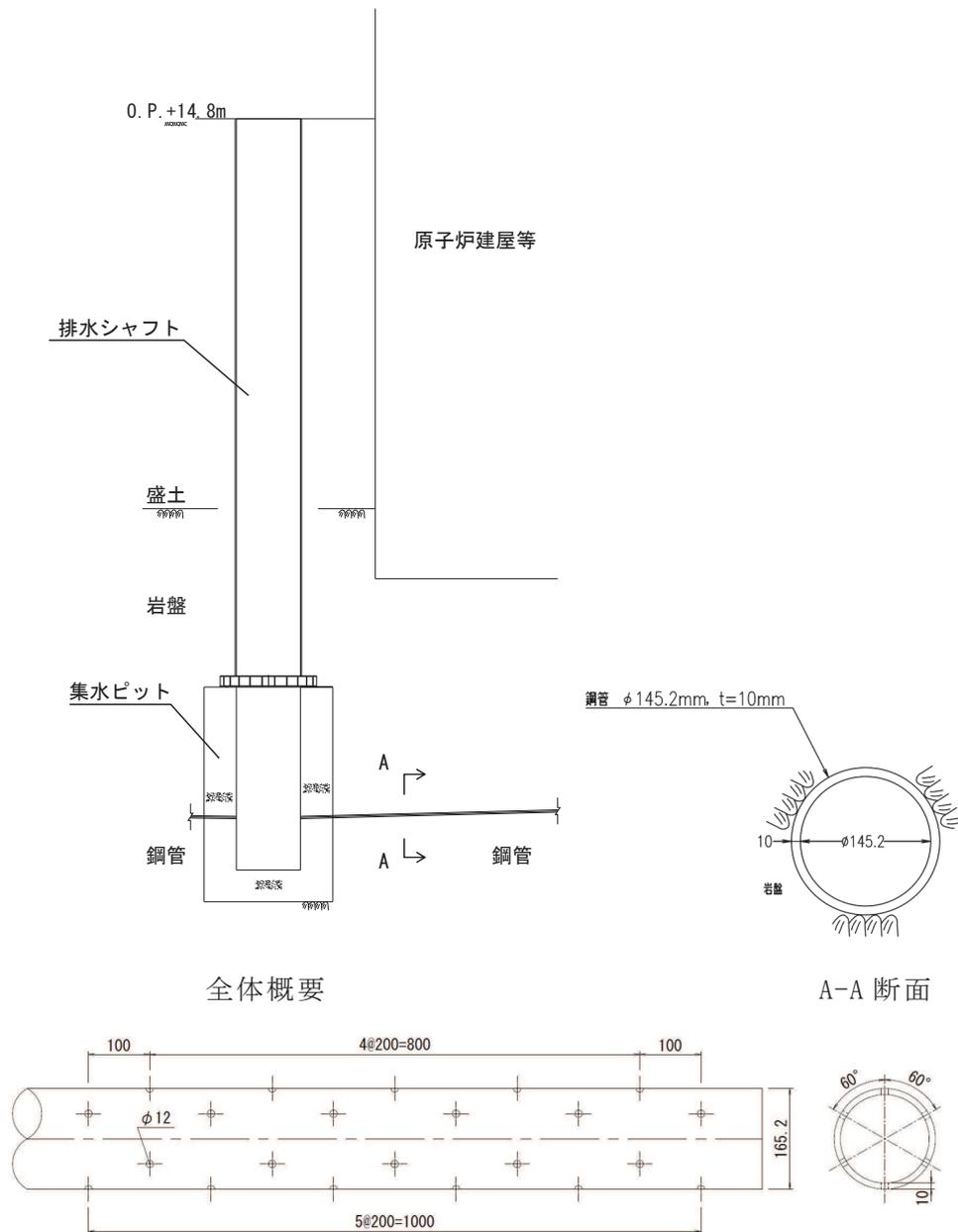
図 2-4 鋼管の構造概要 (単位 : mm)
