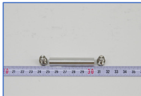
図 4.7-5 引張試験片を収納する管状容器の外観
