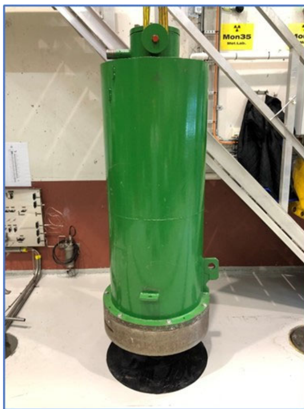
図 4.7-2 IFA-735/736 の試験片を収納した容器の取り出し.
