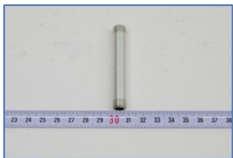
図 4.7-5 引張試験片を収納する管状容器の外観
