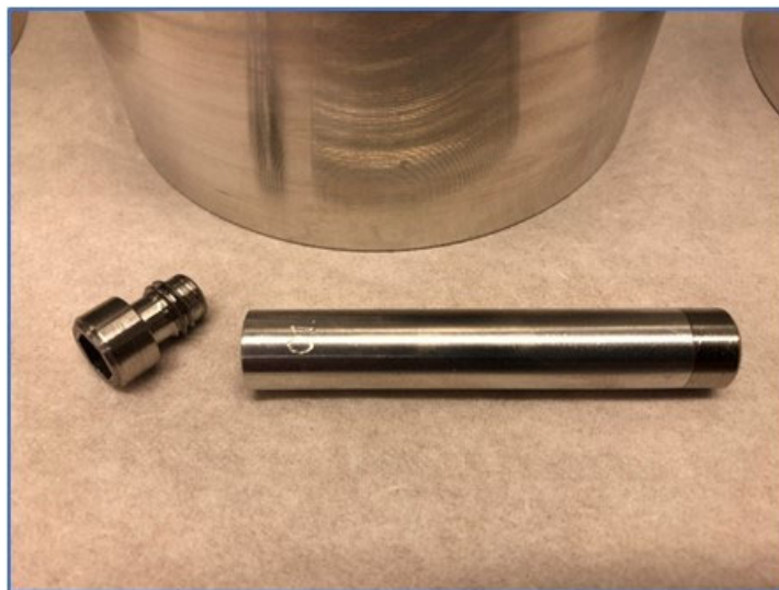
図 4.7-8 ID「01」と刻印された引張試験片用管状容器の外観
