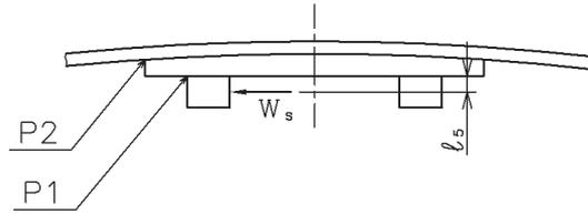
図 5-3 内側フィメイルシヤラグに作用する荷重の状態
