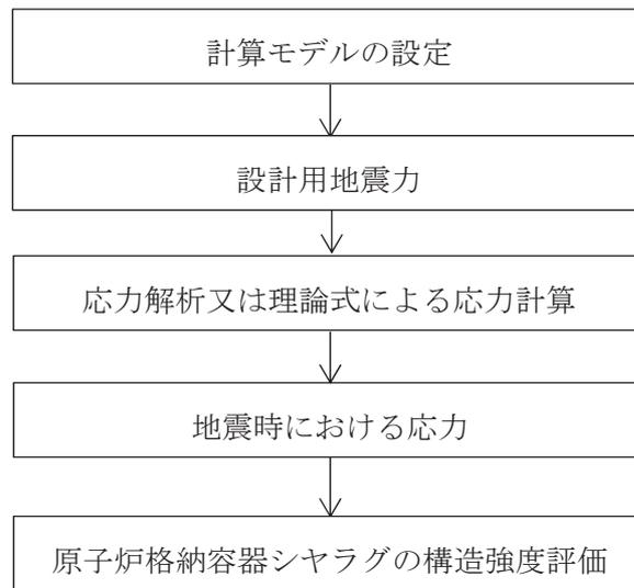
図 2-1 原子炉格納容器シヤラグの耐震評価フロー
