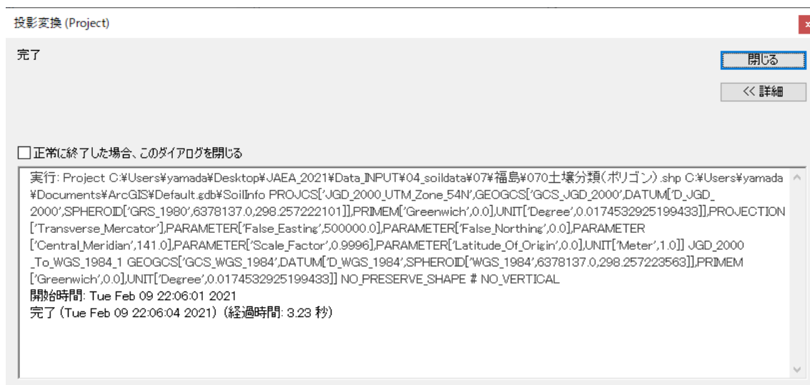
図 3-146 座標系の変換③ (土壌データ)
