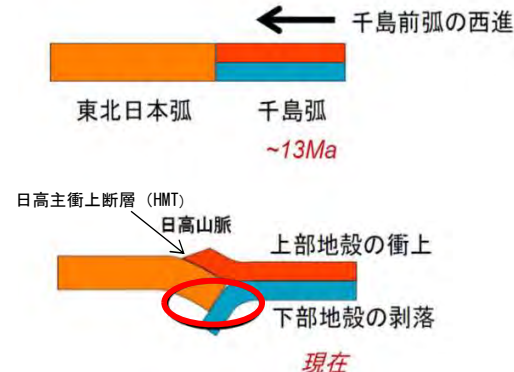
千島弧の前弧スリパーの西進、東北日本弧との衝突による日高山脈形成過程の模式図 日野ほか (2008) (96) に一部加筆
