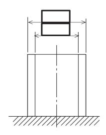
図 3-2 中央燃料支持金具の外荷重による応力計算モデル (単位:mm)
