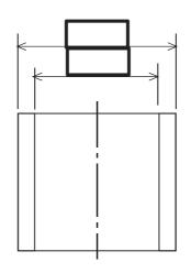
図 3-1 中央燃料支持金具の差圧による応力計算モデル (単位:mm)
