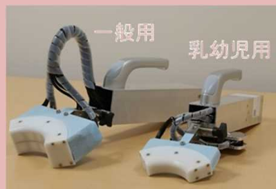
開発した甲状腺モニタ（検出素子には複数の小型GAGG検出器を使用）
