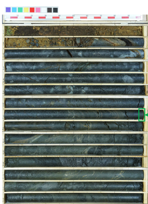
コア写真 (R1敷地-3: 深度0~15m)
