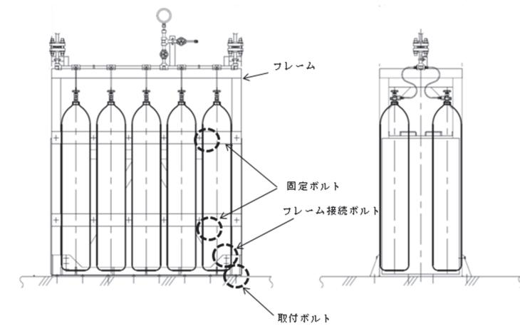
図2-3 ポンベ設備 (ラック型 (床固定型))
