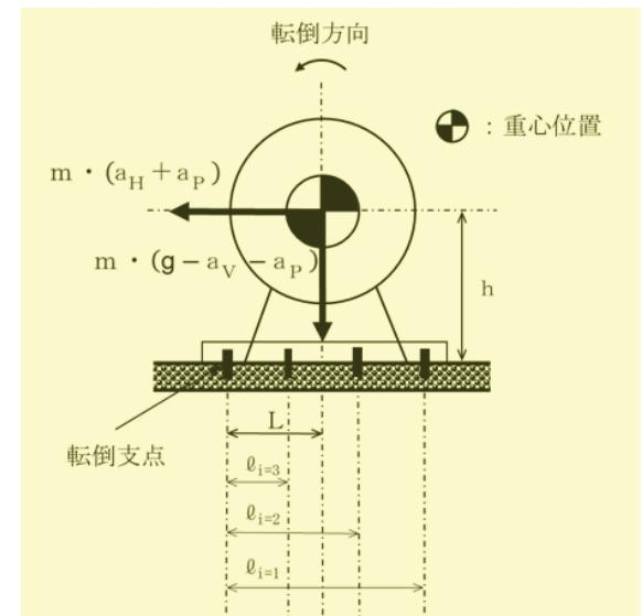
図 4-2 直接支持構造物の計算モデル例 (1/2)
