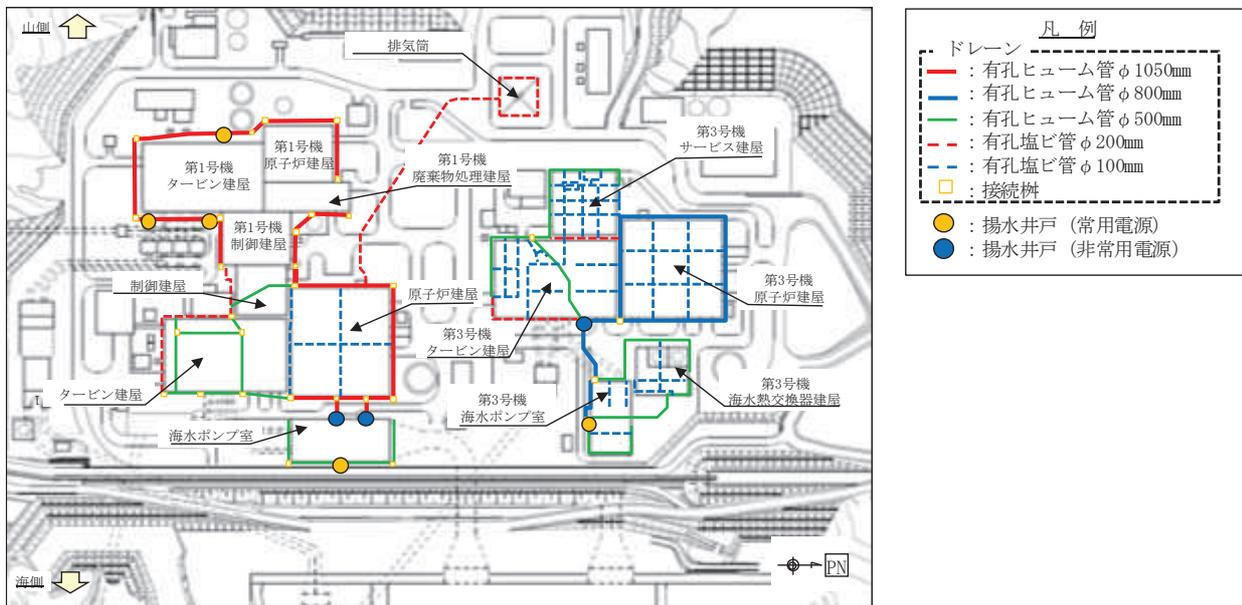
図 4-11 既設の地下水位低下設備の配置
