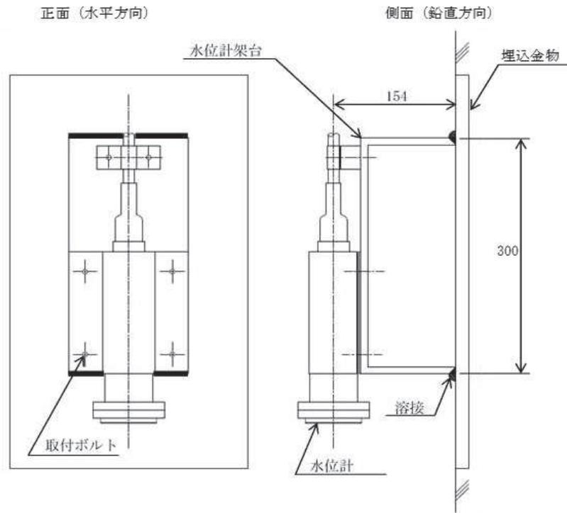
図 4-8 水位計の構造図
