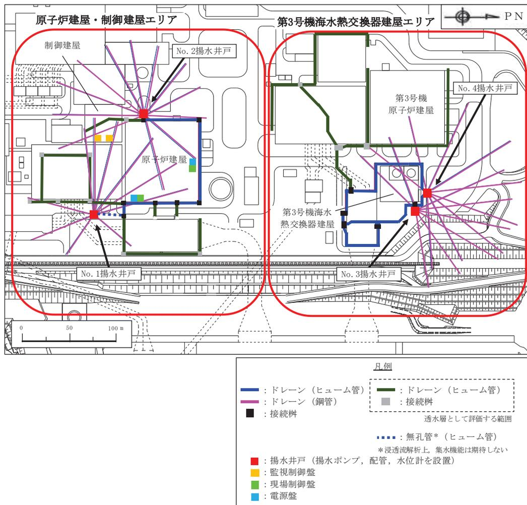
図3-1 地下水位低下設備の配置
