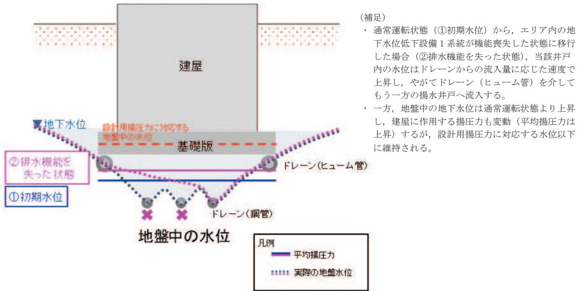
(a) 地盤中の地下水の挙動 (概念図)
