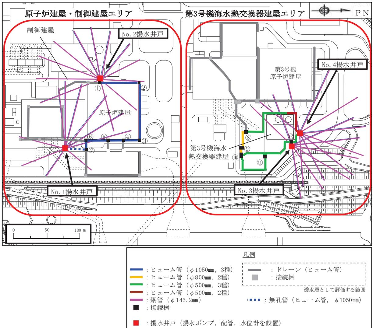
図 4-1 ドレイン及び接続樹 配置概要図
