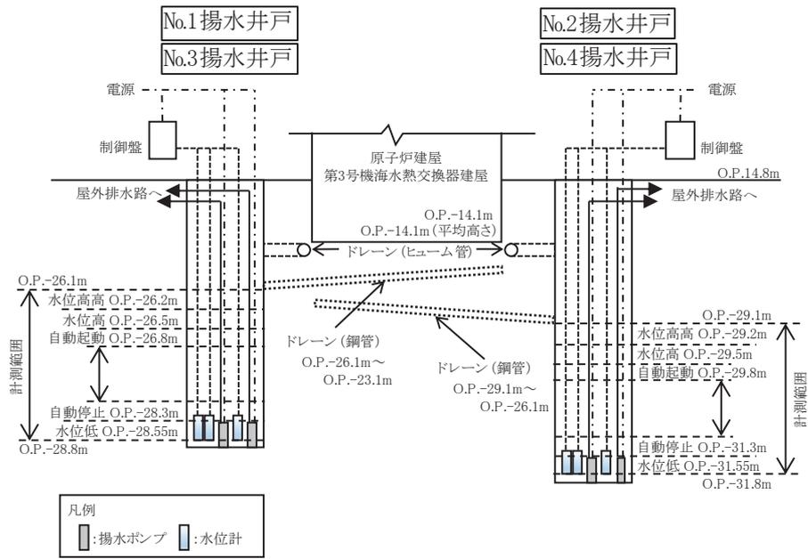
図 4-9 計測範囲，ポンプ制御の概要図
