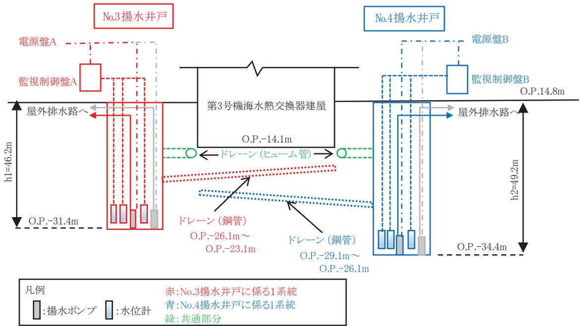
図 3-2 地下水水位低下設備の系統図
