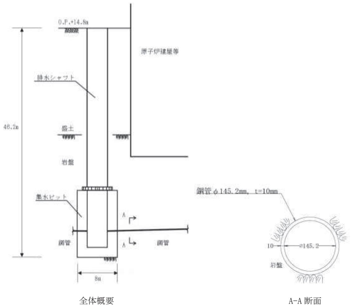
図 4-3 ドレーン（鋼管） 概要図
