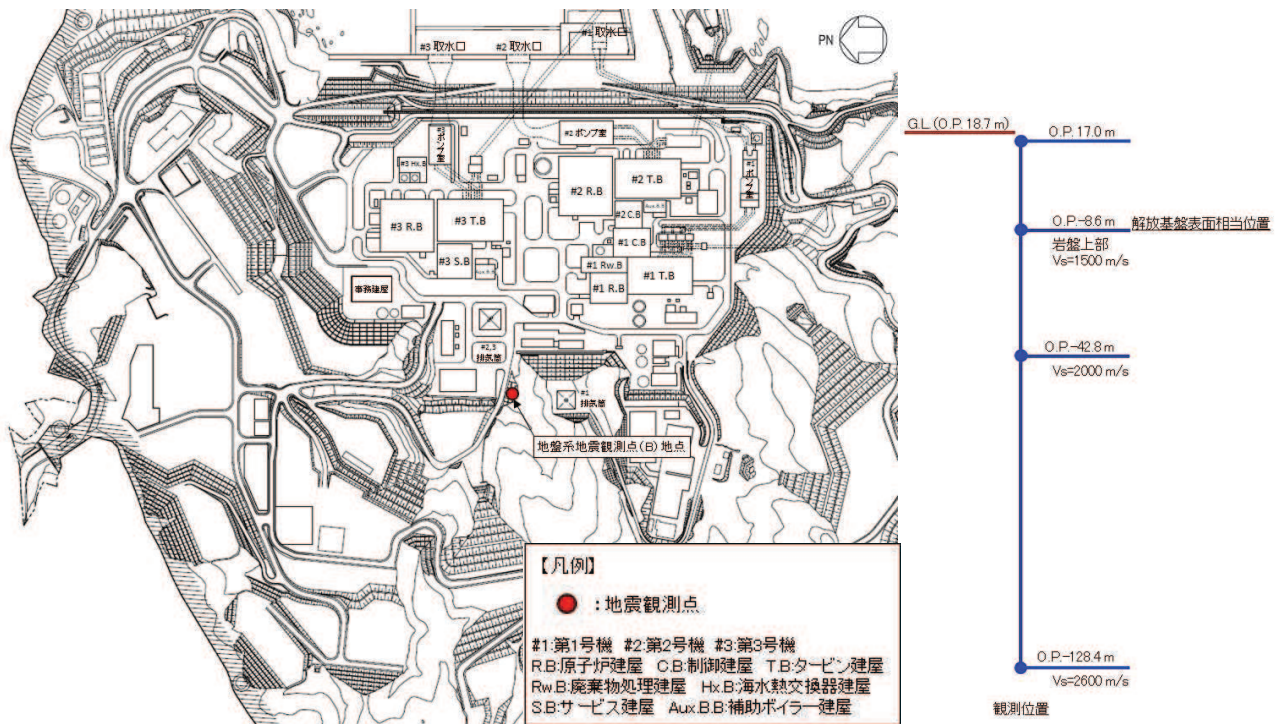
図1-1 女川原子力発電所における地震観測点の位置
