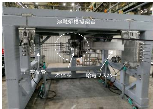
模擬溶融炉架台への据付検査の状況
