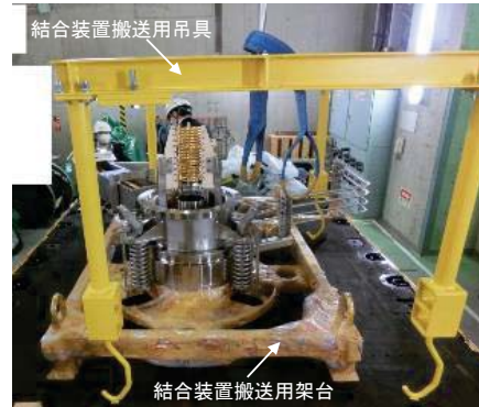
模擬溶融炉架台への据付検査の状況
