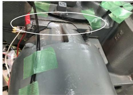
(a) モーター・フレーム上面のひび割れ
