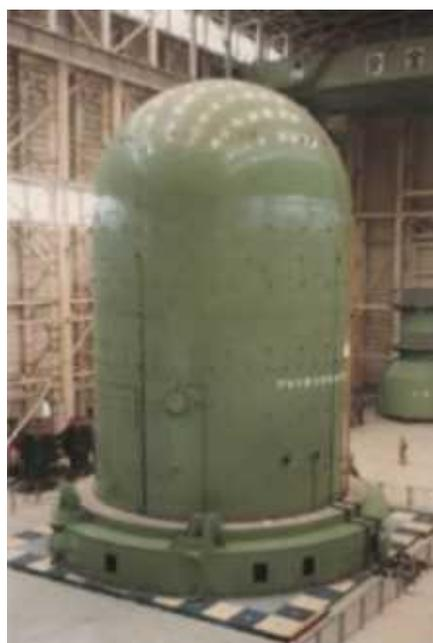
図 2.4.2 PWR-CV の耐震信頼性実証試験体
