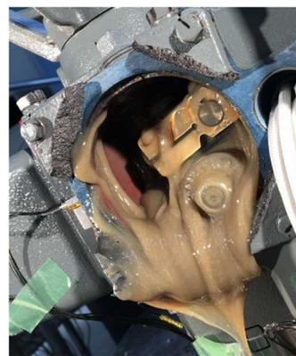
(c) モーター・フレーム損傷面
