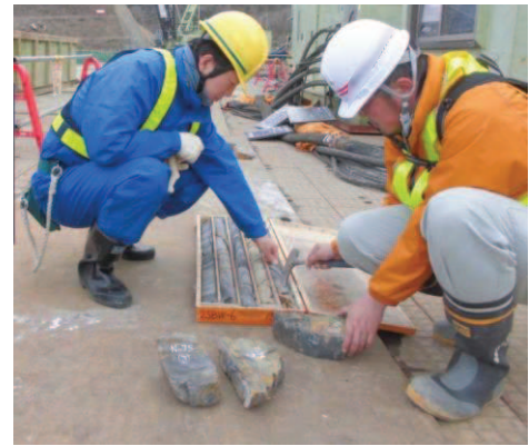
(岩ズリの外観目視・ハンマー打音から風化度を判定。併せて、近傍のボーリングコアと岩相等を対比している。)
