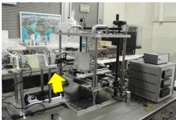
QSTを試験治具に取り付けた様子
