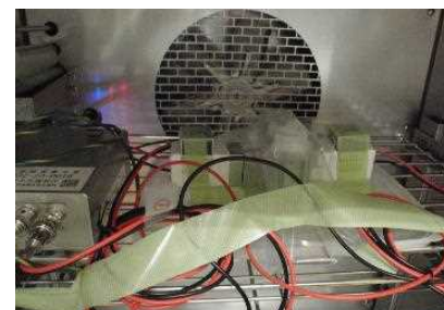
環境試験装置（エスペックLHU-114）に測定器（LaBr 3 遮蔽なし）を設置した様子
