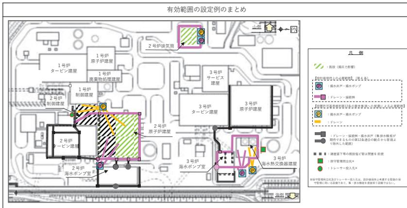
添付 2-13 図 地下水位低下設備の設定例
