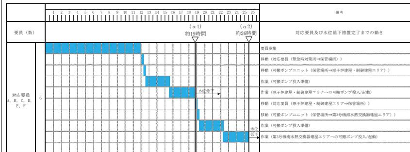
図 6-5 地下水位低下設備機能喪失後の水位低下措置完了時間 (α1 及び α2)
