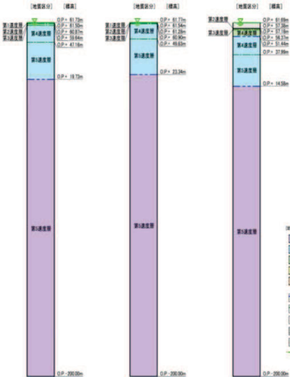
図 3-3 第1 保管エリアの地震応答解析モデル (1次元)
