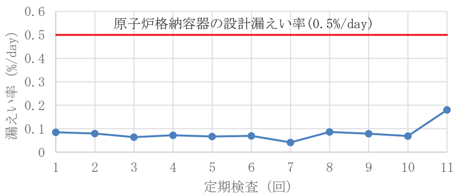
図5 原子炉格納容器全体漏えい率検査実績
