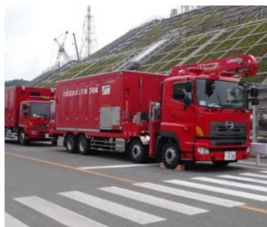
大型送水ポンプ車
