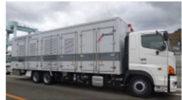
可搬式窒素供給装置
