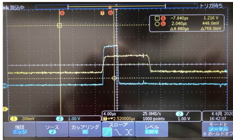
図 42 今回製作した CsI(Tl) 検出器からの典型的な出力信号。黄色の波形がピークホールド出力。青の波形がコンパレータ出力。この場合、コンパレータ出力のタイミングから 8\mu\text{s} 後に外部回路からピークホールド回路向けにリセット信号を送り出している。
