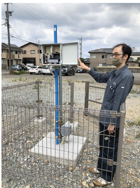
図19 屋外での総合試験用に設置された可搬型モニタリングポスト。
