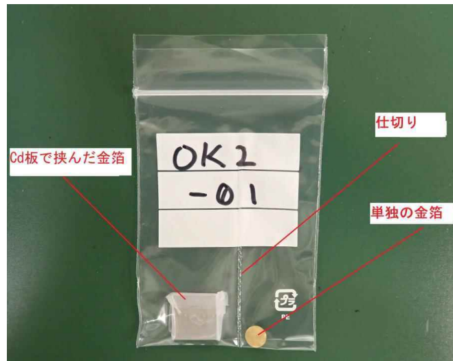
図 2.2 金箔を用いる放射化検出器の例 (単独の金箔及び Cd 板で挟んだ金箔の一組)
