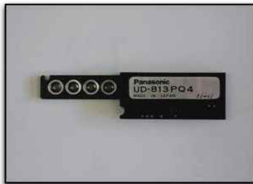
図 2.4 素子を引き出した状態の Panasonic 社製 TLD (UD813PQ4)
