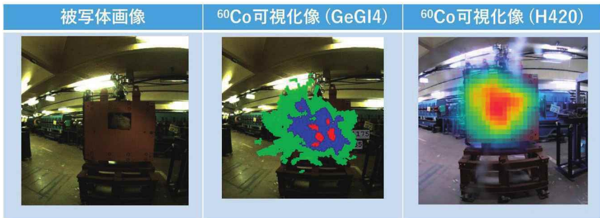
図 5-1 KEK-PS トンネル内において放射化した四重極電磁石を側面より GeGI4 および H420 を用いて撮影した結果の比較
