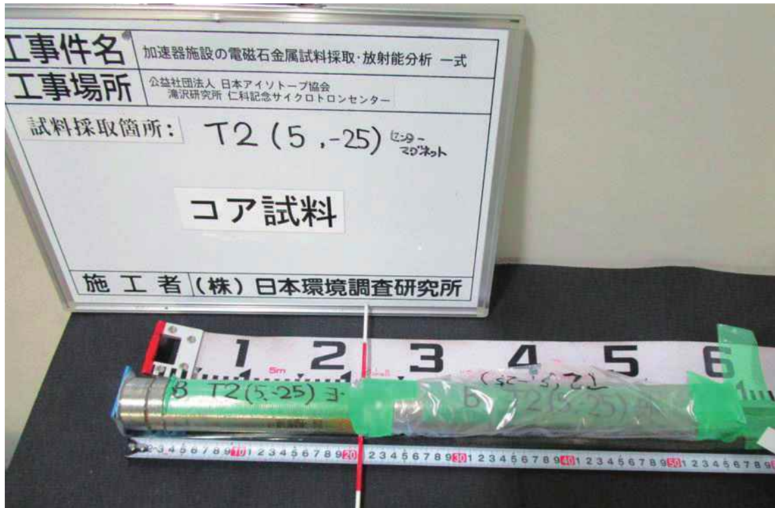
図 4-4 T2 地点より採取したコア試料外観
