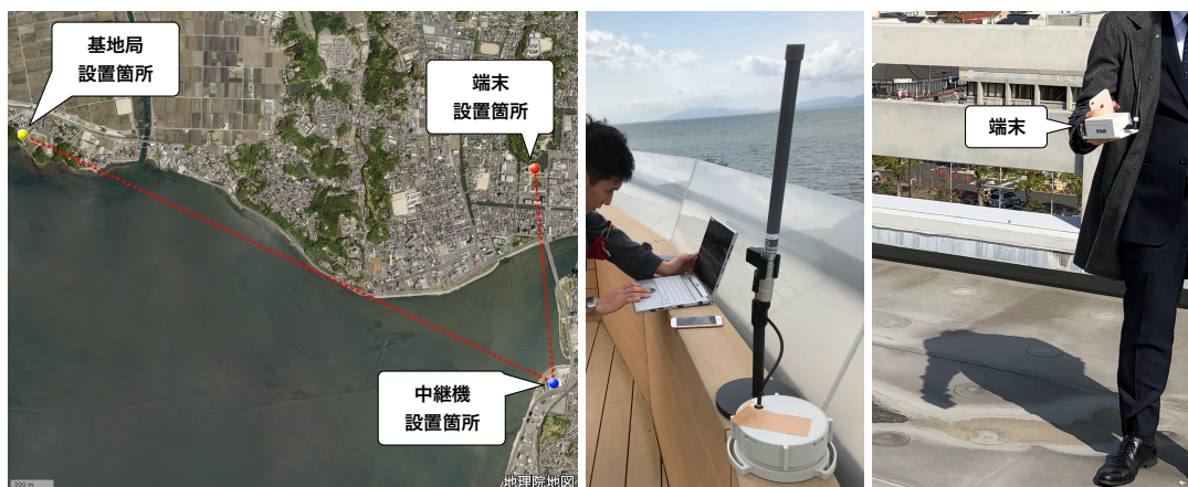
図 36 県庁との通信試験。(左) 基地局、中継機、端末の位置関係。端末と基地局の間は山と市街地のビル等で遮られた状態。(中) 県立美術館屋上に設置した中継機。(右) 県庁屋上に置いた。
