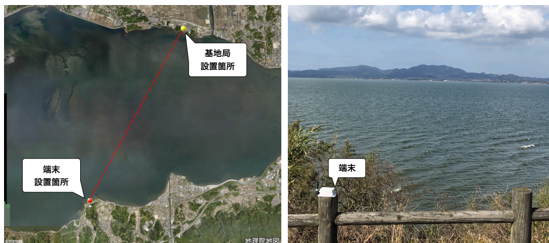
図 37 ふれあいパーク展望台での通信試験。(左) 基地局、中継機、端末の位置関係。障害物はなく見通し可能であるが、距離が 5 km 以上離れている。(右) 端末は手すりの上に置いた。
