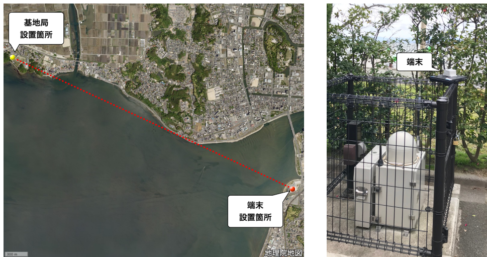
図 35 県立美術館との通信試験。(左) 基地局、端末の位置関係。端末と基地局の経路上に崖が迫り出してわずかに遮る形になっている。この崖の地点に中継機を設置したが、端末は自動的に経路選択し、基地局と直接通信を行った。(右) 端末設置の様子。モニタリングポスト柵の上に置いた。
