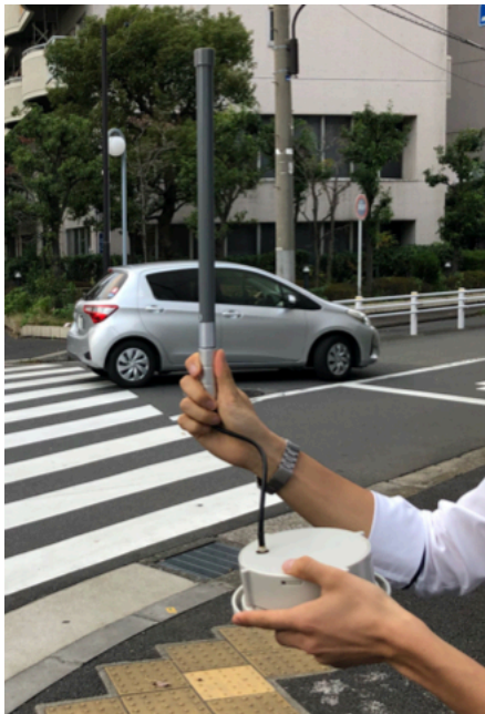
図 26 ZETA 中継器 (左) と ZETA 評価用端末と超小型 KURAMA-II プロトタイプを組み合わせた試験用端末 (右)。いずれも電池駆動が可能で小型軽量である。
