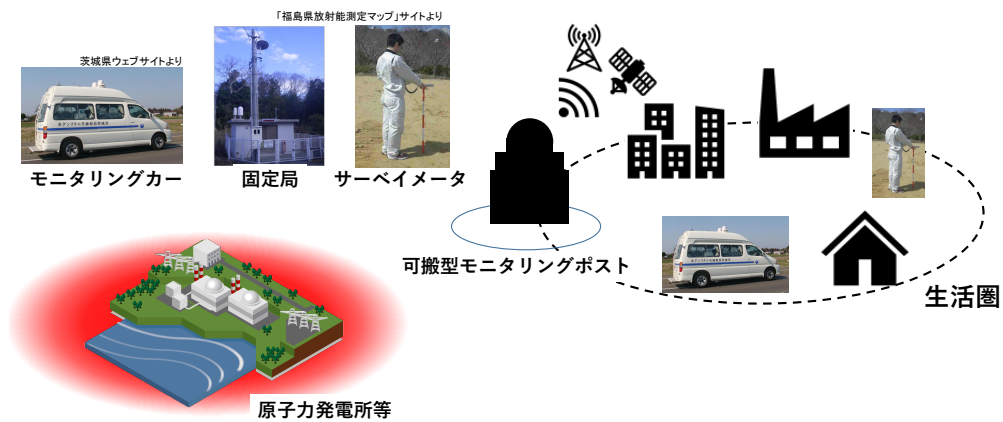
図1 既存のモニタリング機器の位置付け。発災時には可搬型モニタリングポスト、モニタリングカー、サーベイメータが機動的に展開されることになっている。
