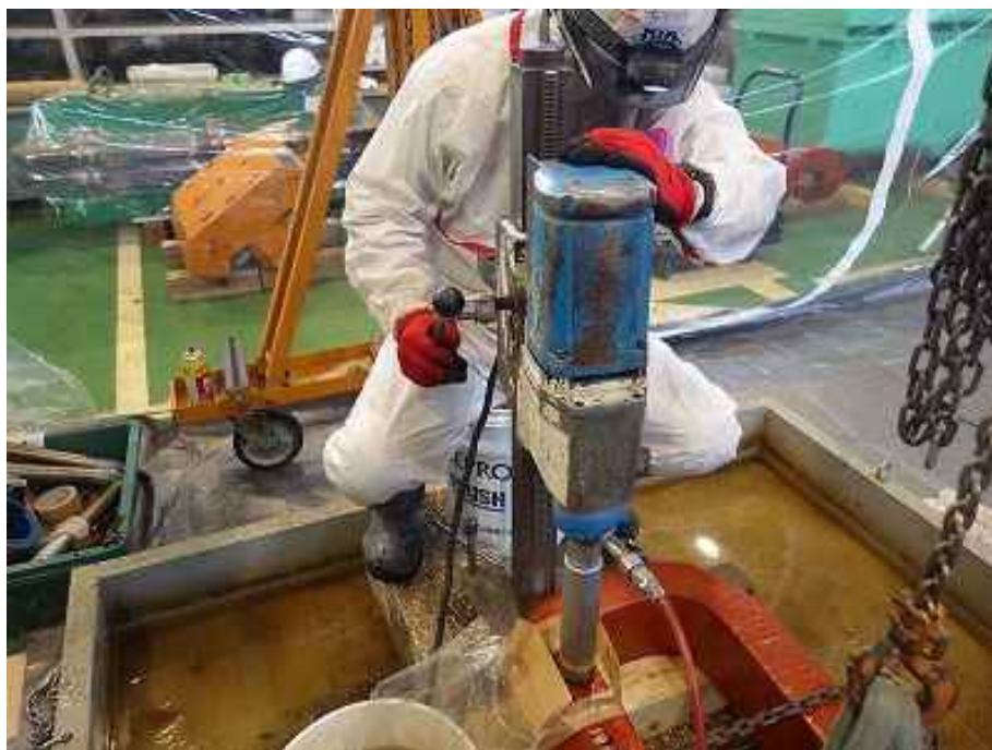
図3-1 電磁石部品からのコア試料採取の様子
