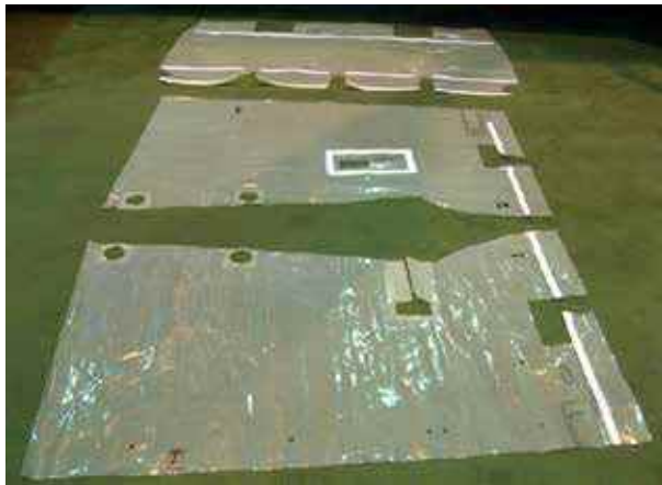
図7 切り抜いた養生シート ベルト等を通す部分はテープで補強する。
