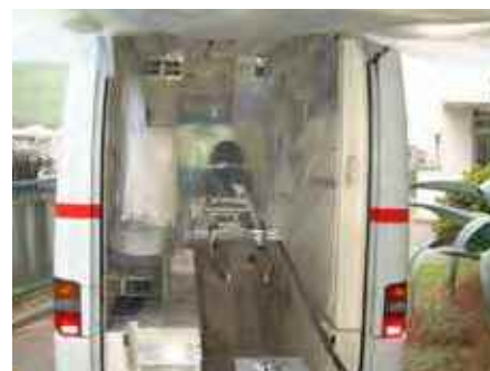
図3 車両内部の養生
