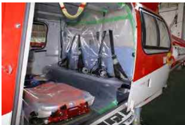
図9 養生シートの貼付 辺縁はテープでしっかりと貼り付ける。 ベルトなどはビニールに切り込みを入れてだす。ベルト自体は、傘用のビニール袋などを利用すると養生が容易である。
