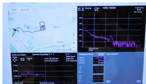
図 4-4 ラジプロブシステムの画面 複数の拠点で、リアルタイムの測定結果を共有した。
