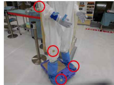
検知紙を貼付(○部分)
