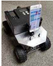
CR警報器をクローラーに設置しリモート会議のアプリを同時起動させ、現場の状況を伝送
