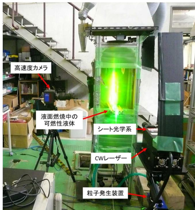
図 2.4.4.1 液面燃焼試験体系及び PIV 測定体系<sup>22</sup>
