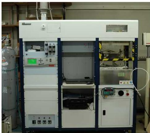
図 2.3.2.1 電気ケーブル熱劣化試験装置<sup>20</sup>
